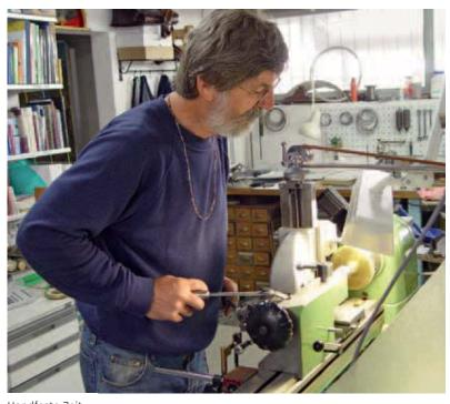
Handfeste Zeit-Philosophie: Miki Eleta bearbeitet an der Drehbank ein Messingstück Schritt für Schritt, bis ein Zahnrad entsteht. Und die Beziehungen zwischen vielen solcher Zahnräder ermöglicht es, die Zeit zu teilen.
